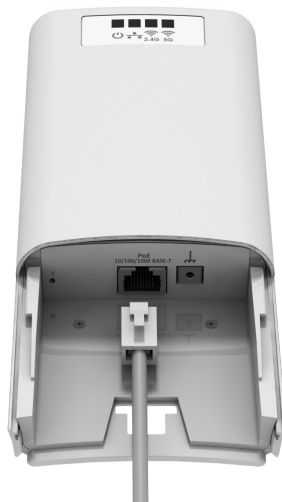
Рисунок 11 — Подключение Ethernet-кабеля к PoE-порту
