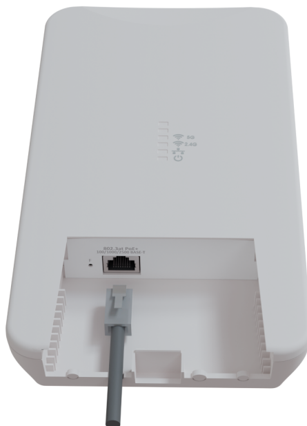
Рисунок 13 — Подключение Ethernet-кабеля к PoE-порту
