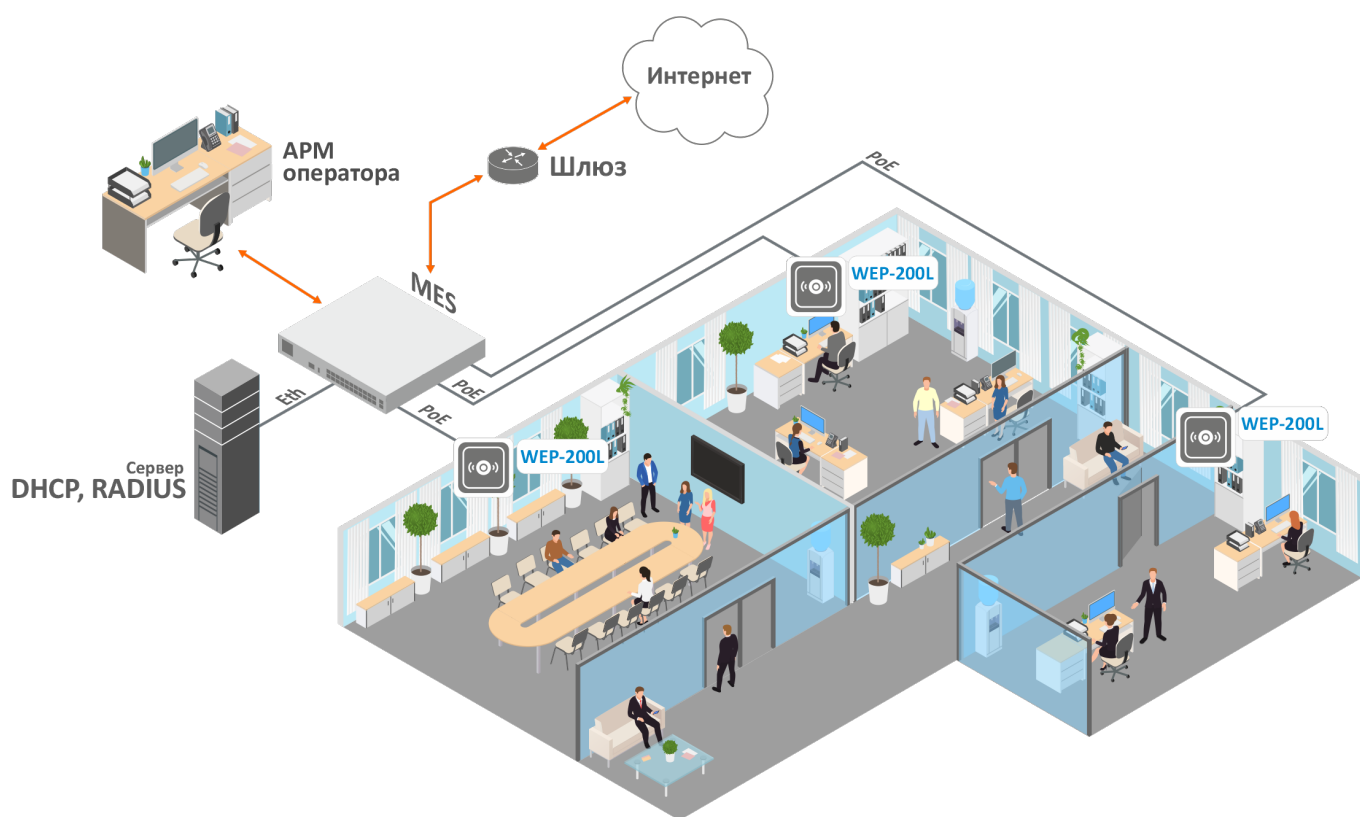
Рисунок 1 — Функциональная схема использования WEP-200L
